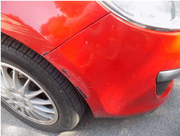
3. RENAULT CLIO – oštećenje branika
