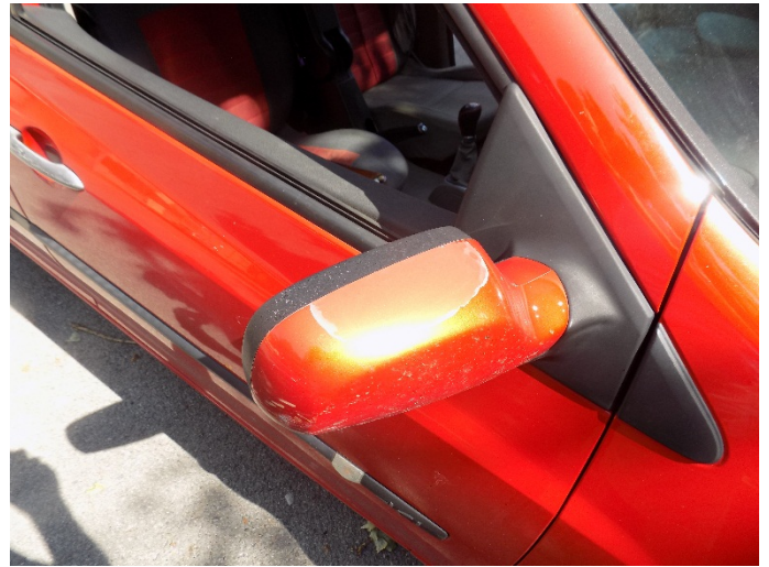
4. RENAULT CLIO – oštećenje retrovizora
